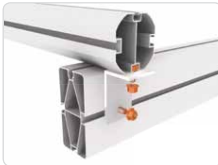
L5 2x11 (11 und 11 mm Loch); Verbindung von Big 101 und Big 150 Profilen
